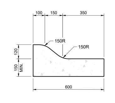
**MOUNTABLE CURB & GUTTER** SCALE 1:10
