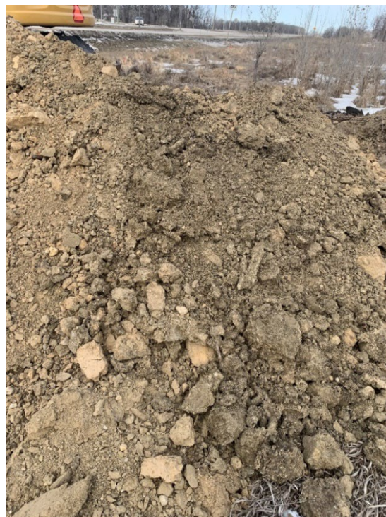
TP24-01 Photo 2: Clay -rich Silt Till
