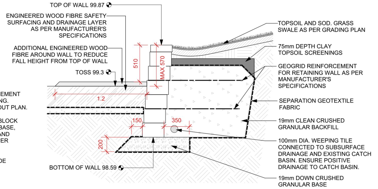
2 **RETAINING WALL AGAINST SOD**
