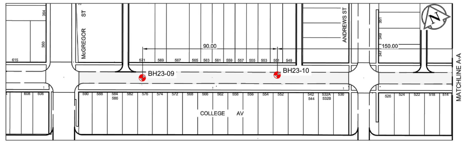
NOTE: -DRILL PAVEMENT CORE ONLY EACH TEST HOLE LOCATION
