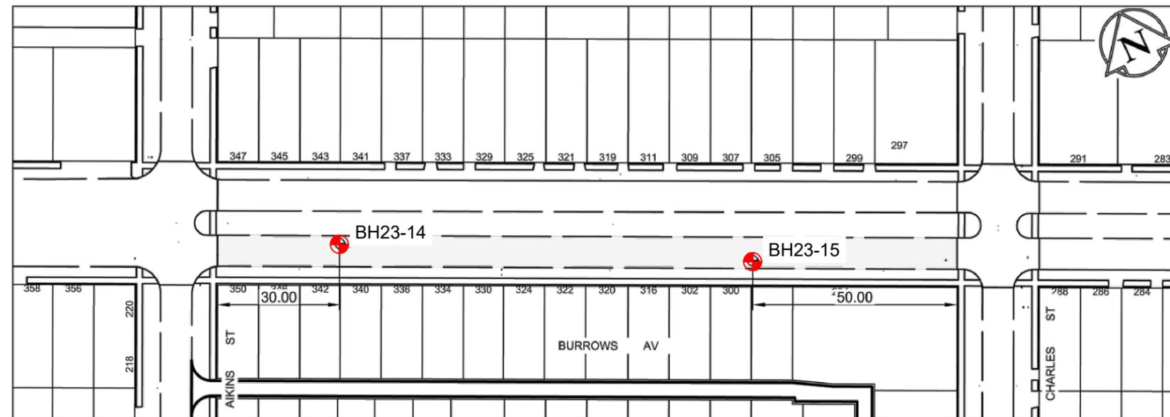
NOTE: -DRILL PAVEMENT CORE ONLY EACH TEST HOLE LOCATION
