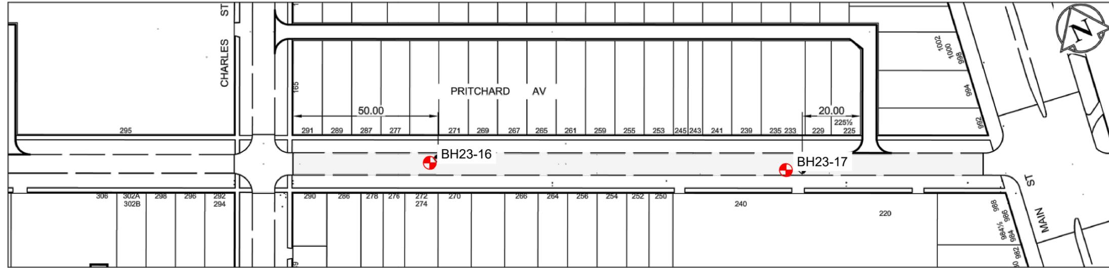
NOTE: -DRILL PAVEMENT CORE ONLY EACH TEST HOLE LOCATION
