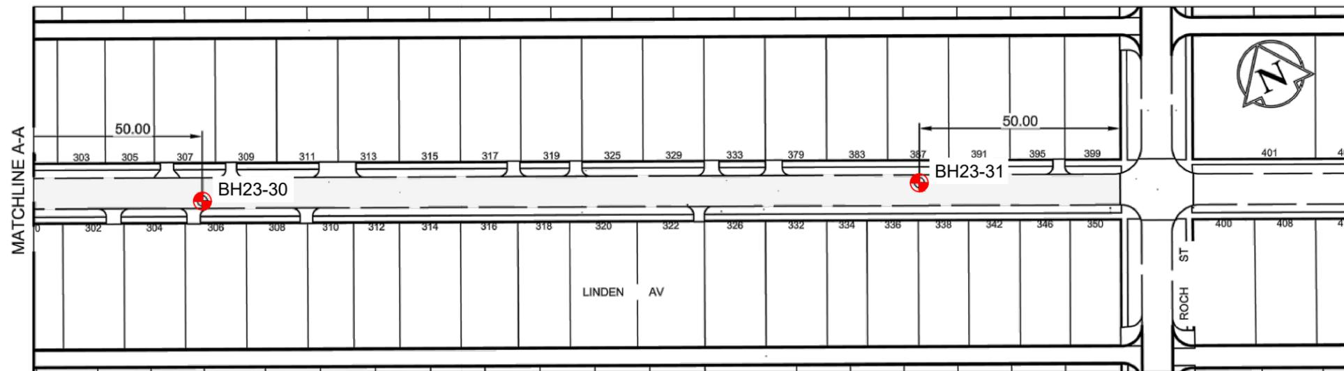
NOTE: -DRILL PAVEMENT CORE ONLY EACH TEST HOLE LOCATION
