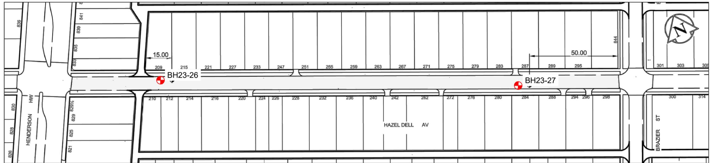
NOTE: -DRILL PAVEMENT CORE ONLY EACH TEST HOLE LOCATION
