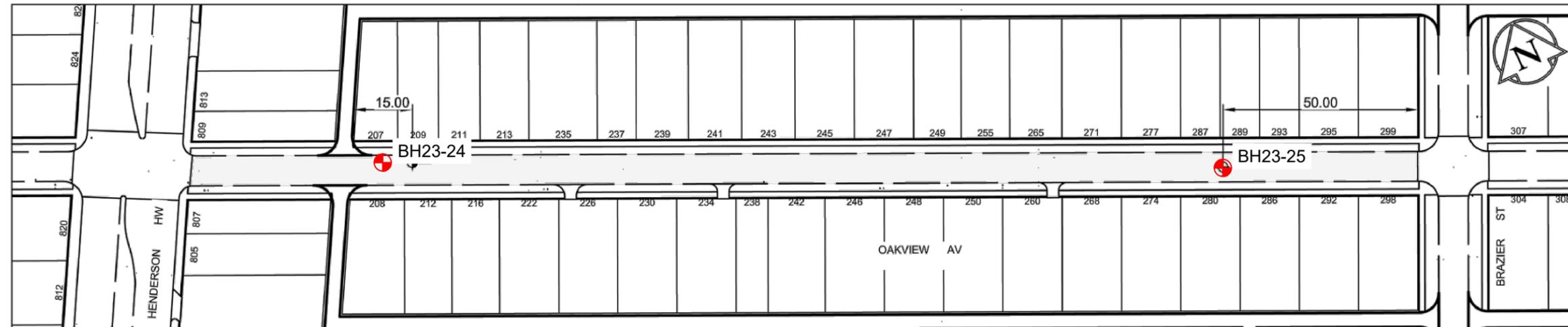
NOTE: -DRILL PAVEMENT CORE ONLY EACH TEST HOLE LOCATION
