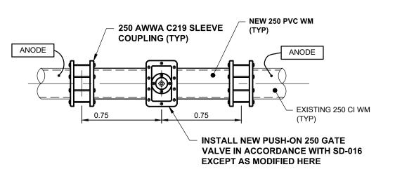
**DETAIL 3** GATE VALVE INSTALLATION
