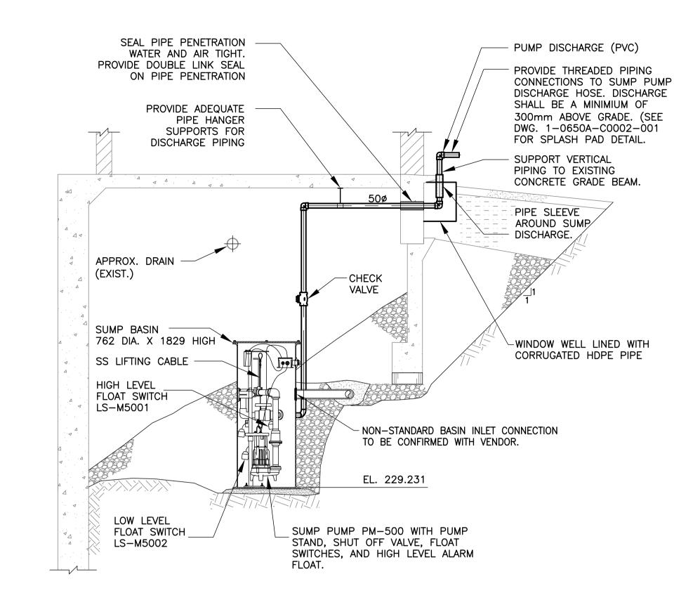
DETAIL - SUMP BASIN AND PUMP (SUMP PUMP P-M500) 0650M-M0001 <sub>SCALE: N.T.S.</sub>
