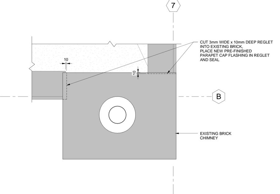
**4 NEW PARAPET CAP FLASHING DETAIL**
