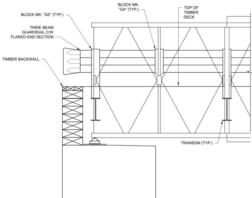
**PARTIAL GUARDRAIL ELEVATION**
