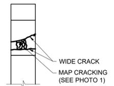
**CENTRE PIER CAP EAST END ELEVATION**
