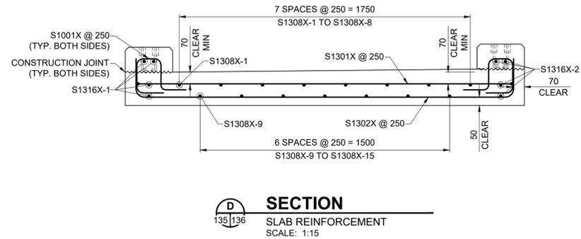
**SLAB-ON-GRADE REINFORCEMENT LAYERS**
