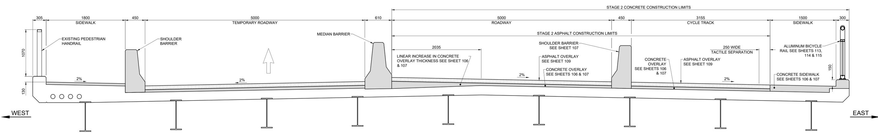
**TYPICAL SECTION - CONSTRUCTION STAGING**
