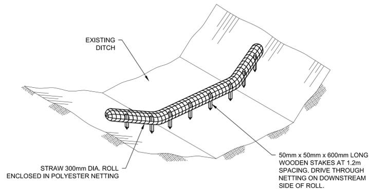
**5** TYPICAL STRAW ROLL DITCH CHECK DETAIL
