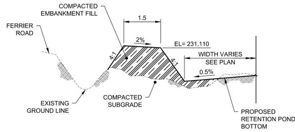
**3** 1.5 m WIDE PERIMETER BERM DETAIL – ALONG FERRIER ROAD
