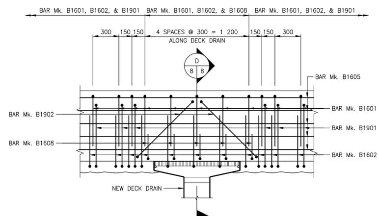
**TYPICAL CONCRETE TRAFFIC BARRIER
