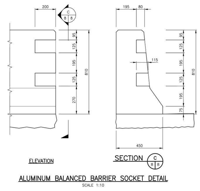
**ALUMINUM BALANCED BARRIER SOCKET DETAIL**
