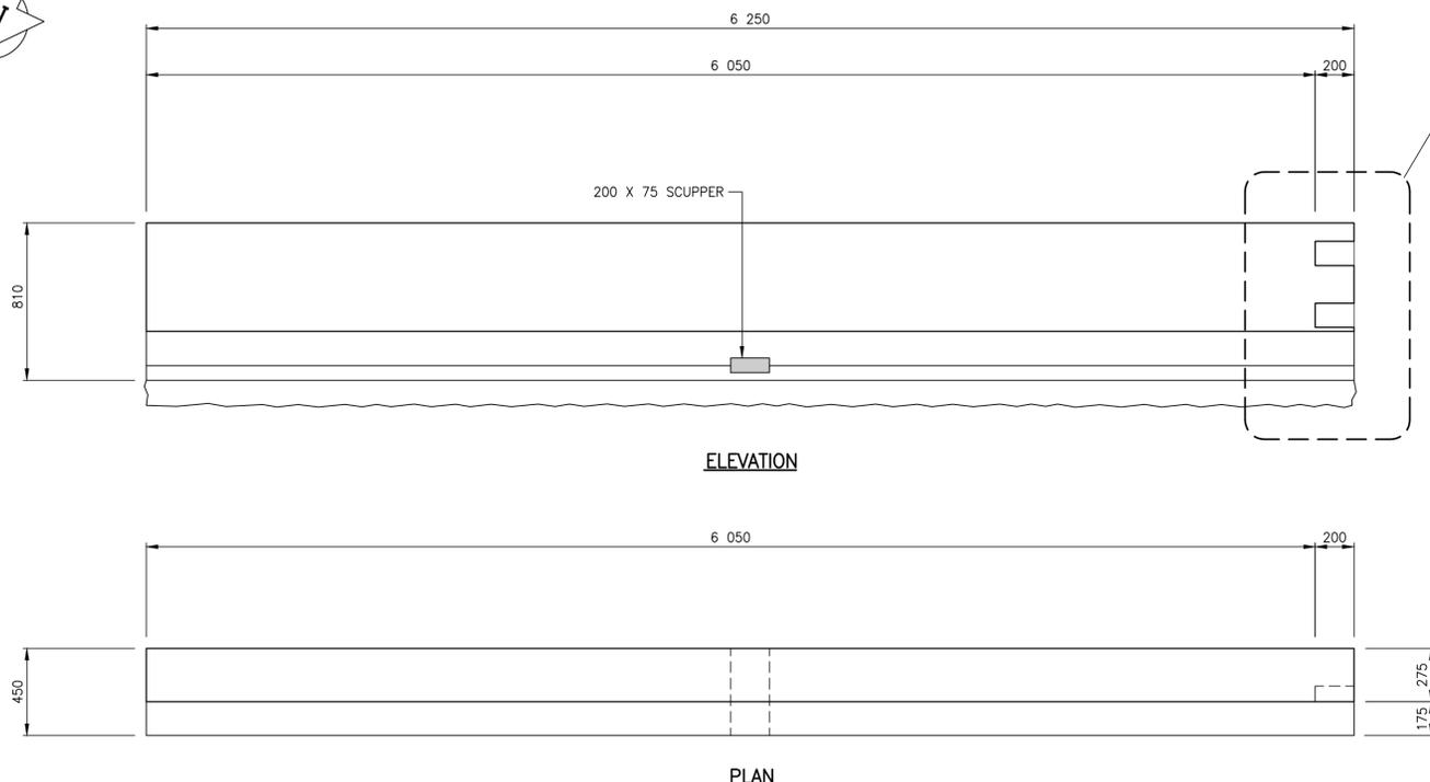
**CONCRETE TRAFFIC BARRIER - TYPE "E"**
