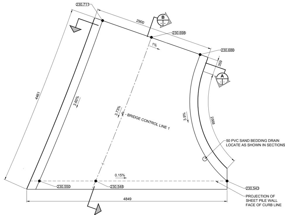
**1** **DETAIL - SOUTH JUMP SLAB PLAN**
