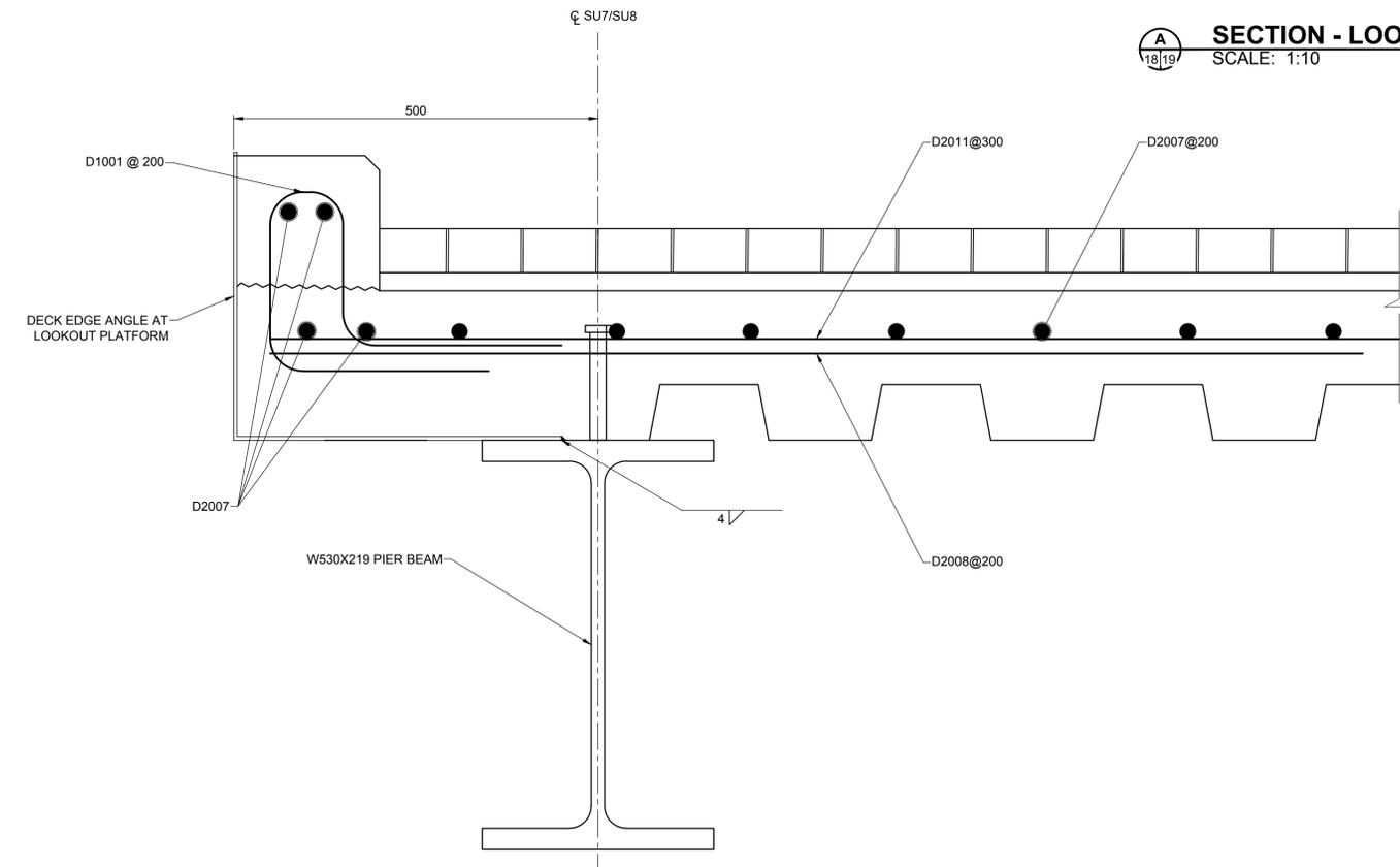
**SECTION - LOOKOUT PLATFORM CANTILEVER REINFORCEMENT**
