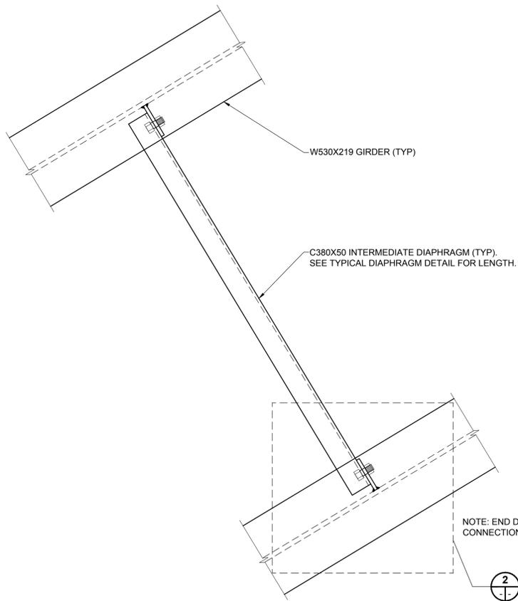
**1** **DETAIL - DIAPHRAGM TO GIRDER CONNECTION**
