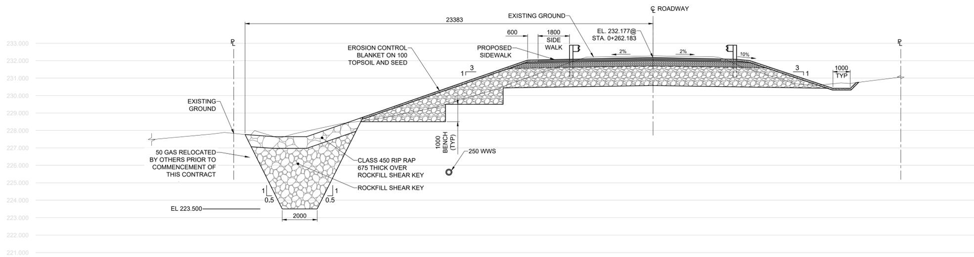
**G** SECTION - NORTH SIDE ROCK KEY SLOPE STABILIZATION
