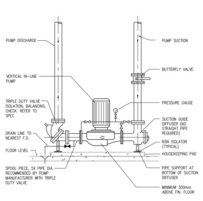
VERTICAL IN-LINE PUMP INSTALLATION N.T.S.
