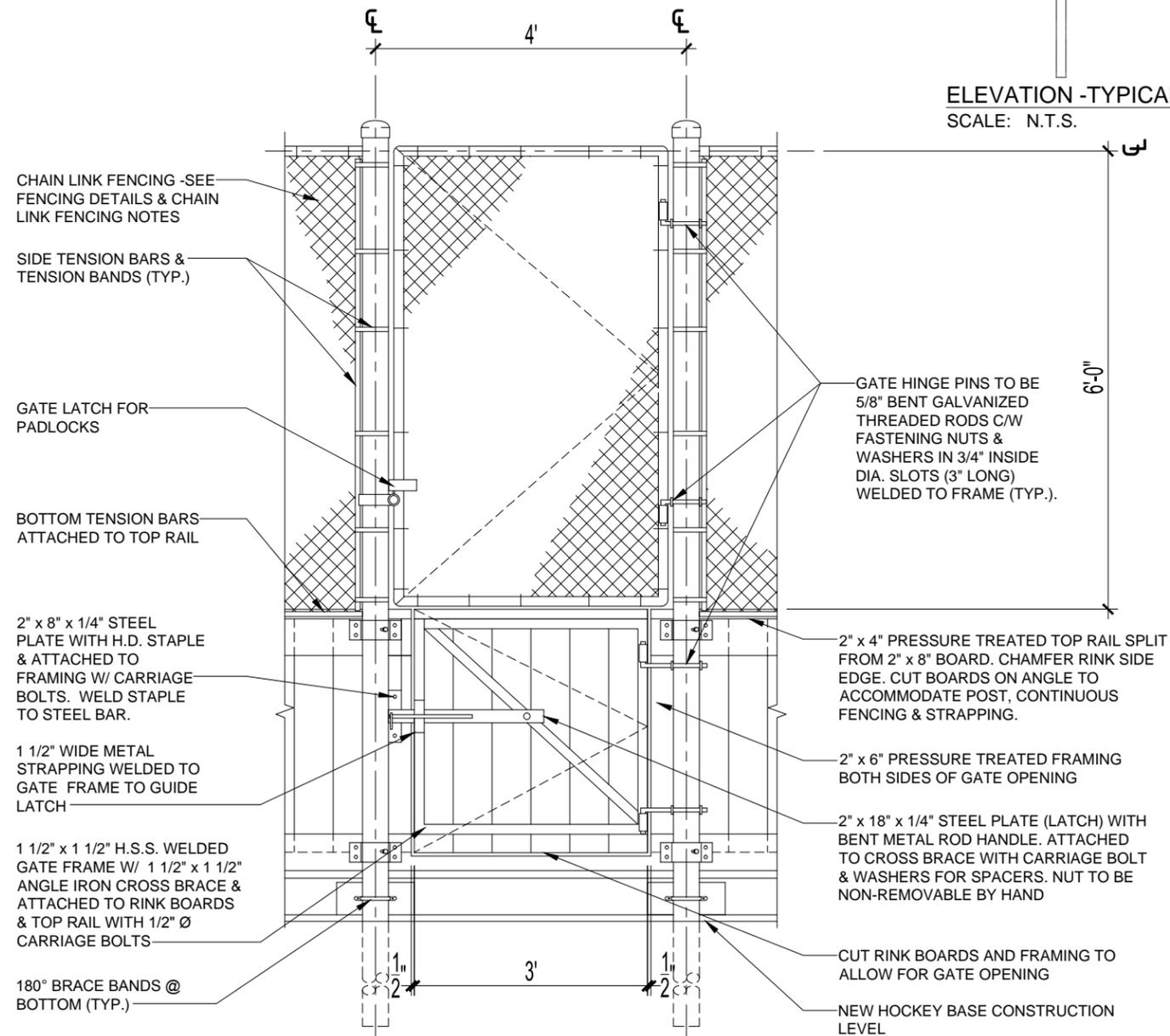
**TYPICAL ELEVATION -ACCESS GATES W/ FENCING**
