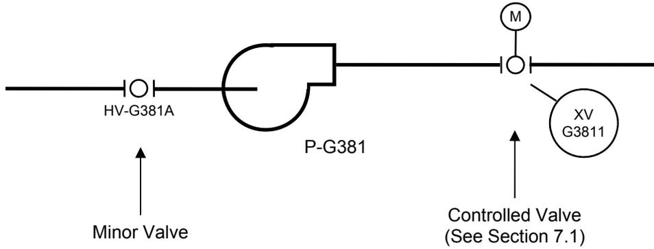
**Figure 5-1 : Valve Identification**
