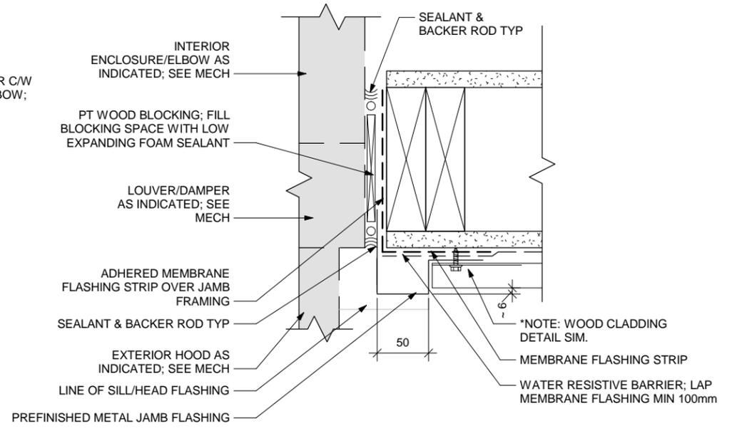
2 PLAN DETAIL - TYPICAL MECHANICAL PENETRATION
