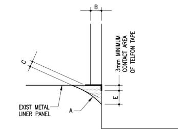
\* FOR JOINT LESS THAN 3mm
