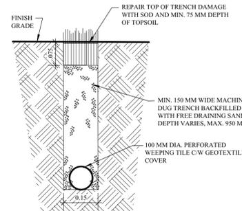
**5 WEeping TILE IN SAND BACKFILL SECTION**
