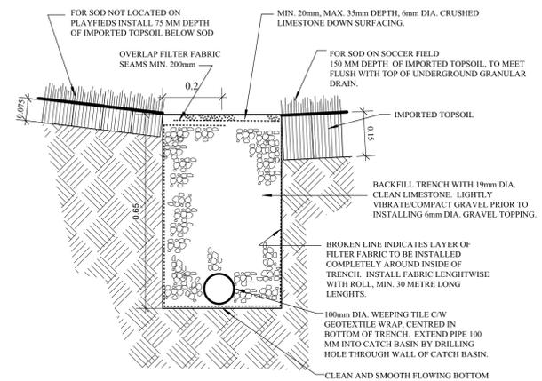
**3 UNDERGROUND CHANNEL SECTION @ DEEPER POINT**
