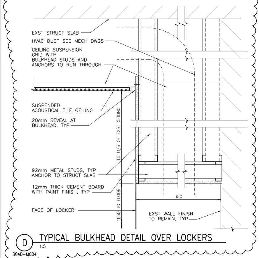
**D TYPICAL BULKHEAD DETAIL OVER LOCKERS**
