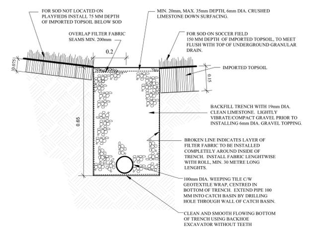
1 UNDERGROUND CHANNEL SECTION @ DEEPER POINT
