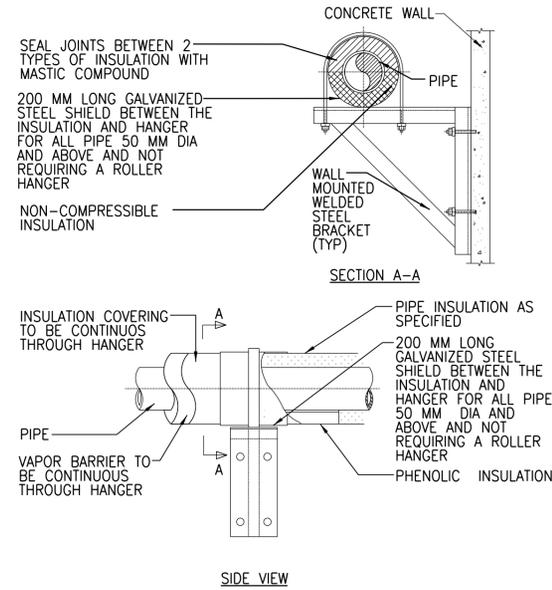
TYPICAL PIPE INSULATION DETAIL (BRACKET)
