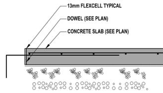
**1 TYPICAL SLAB ON GRADE DETAIL**
