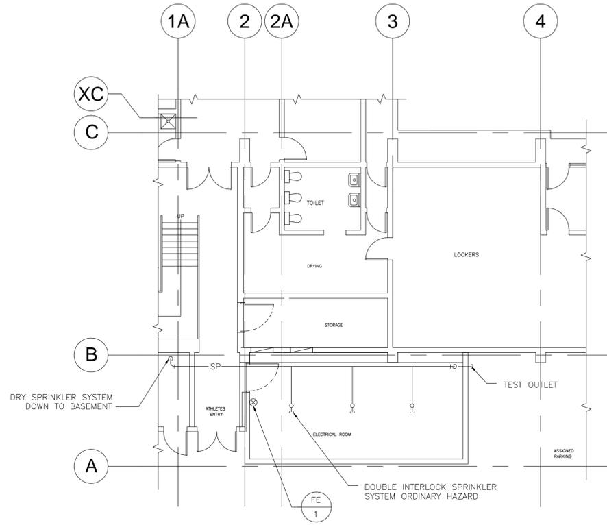
**MAIN LEVEL - ELECTRICAL ROOM - FIRE PROTECTION PLAN**
