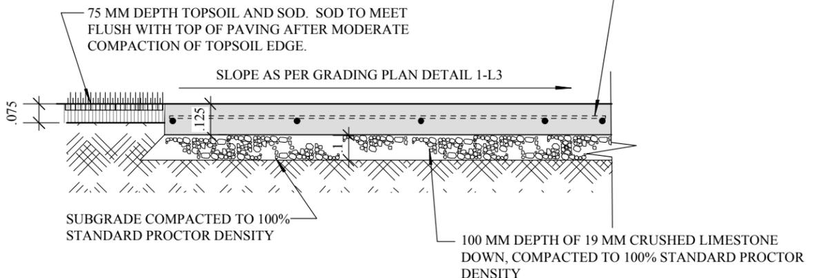
**3 CONCRETE PAVING SECTION**
