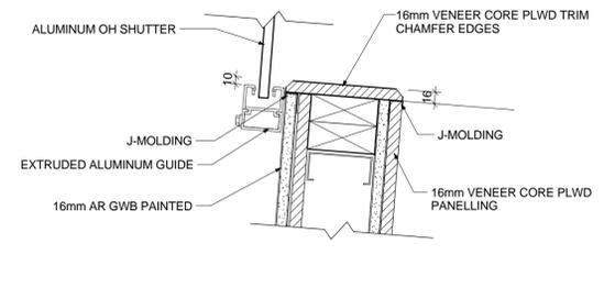
7 TYPICAL COUNTER DOOR JAMB PLAN DETAIL
