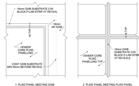
12 TYPICAL PLWD FINISH PANEL AT CORNERS - ELEVATION
