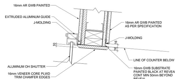
6 TYPICAL COUNTER DOOR JAMB PLAN DETAIL
