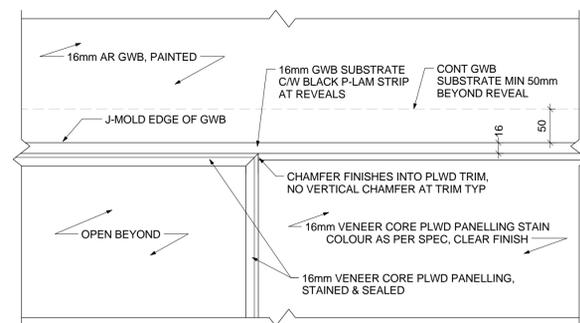
9 TYPICAL PLWD FINISH PANEL AT OPENING - ELEVATION
