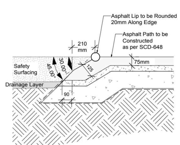
**4 ROLLED ASPHALT EDGE**
