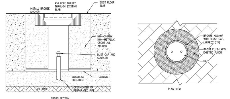
**DETAIL - FLOOR SLAB GAS PROBE**
