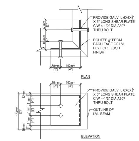
**6 CANTILEVERED BEAM CORNER DETAIL**
