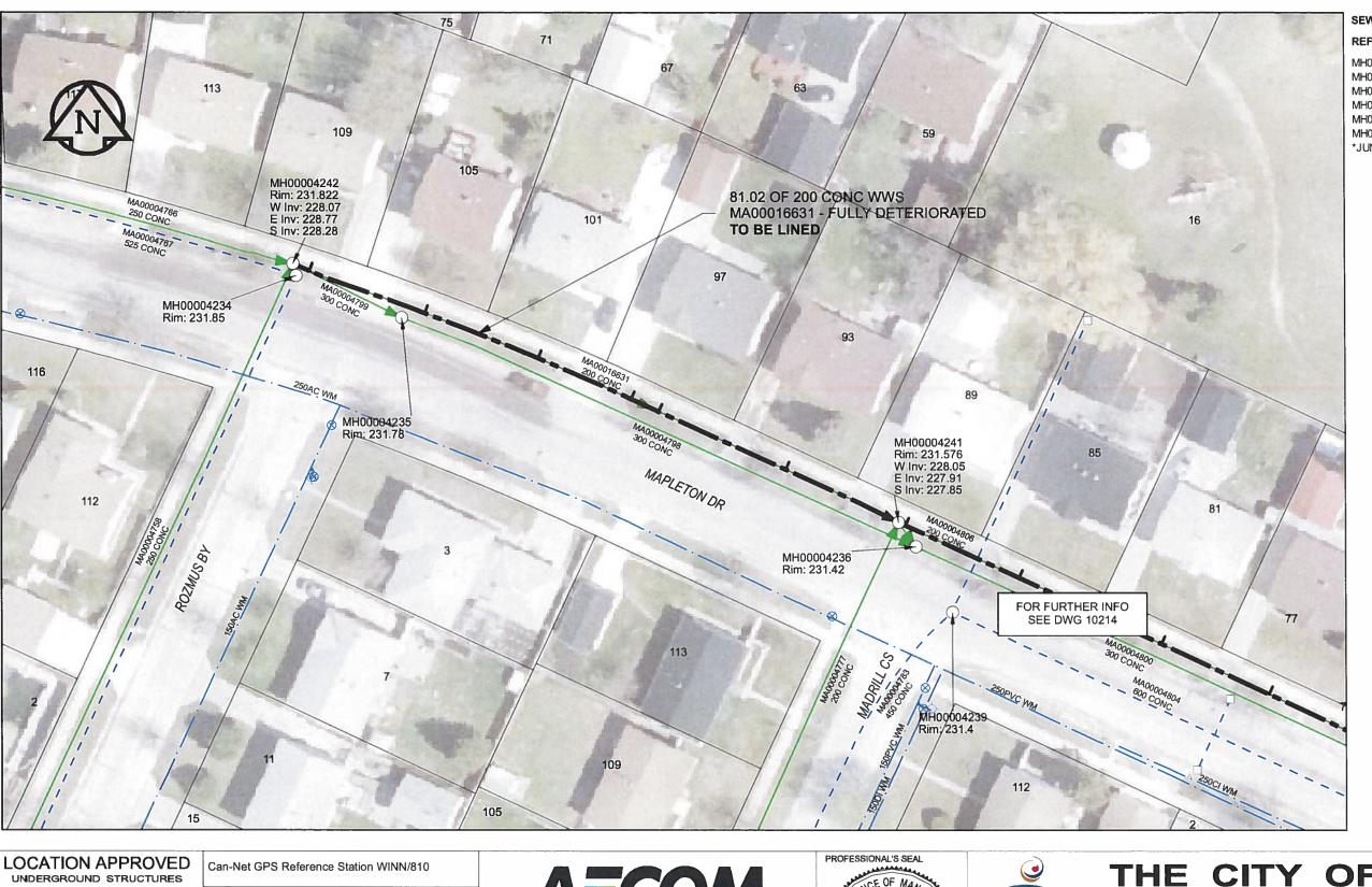
SEWER JUNCTION INFORMATION **DIST FROM\*** SIZE\* CLOCK AT\* MH00004242 2.2 150Ø 10 MH00004242 17.3 150Ø 10 MH00004242 32.3 150Ø 11 MH00004242 44.8 150Ø 10 MH00004242 48.5 150Ø 10 MH00004242 65.7 150Ø \*JUNCTION INFORMATION FROM VIDEO INSPECTION
