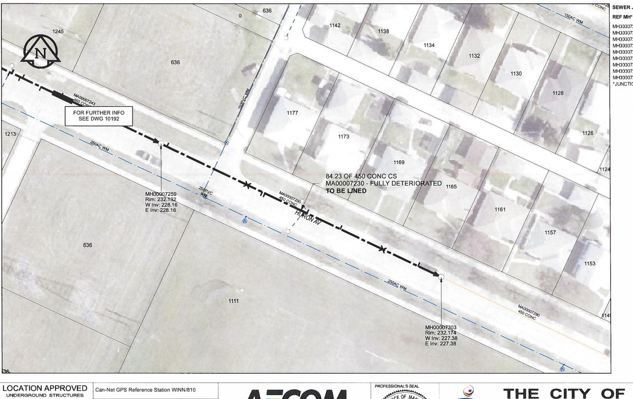
SEWER JUNCTION INFORMATION DIST FROM CLOCK AT\* MH00007259 150Ø 1.8 MH00007259 26 150Ø 12 MH00007259 150Ø 03 30.5 MH00007259 31.3 150Ø 03 MH00007259 43 150Ø 02 MH00007259 43.9 150Ø 09 MH00007259 53.9 150Ø 10 MH00007259 66.7 150Ø 12 77.3 MH00007259 150Ø 10 \*JUNCTION INFORMATION FROM VIDEO INSPECTION
