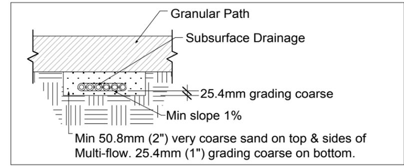
**SUBSURFACE DRAINAGE UNDER PATH - NTS**
