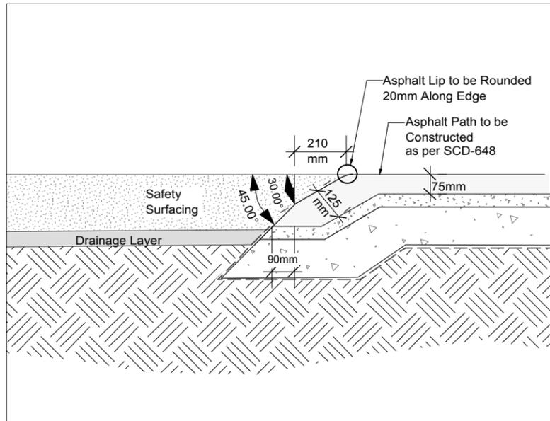
**1** DETAIL - ASPHALT ROLLED EDGE
