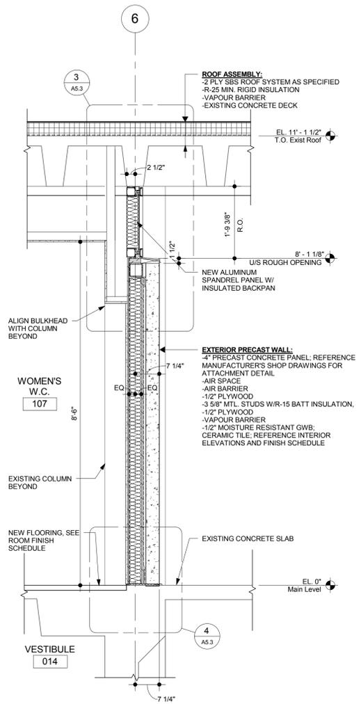
1 WALL SECTION- TYPICAL PRECAST WALL
