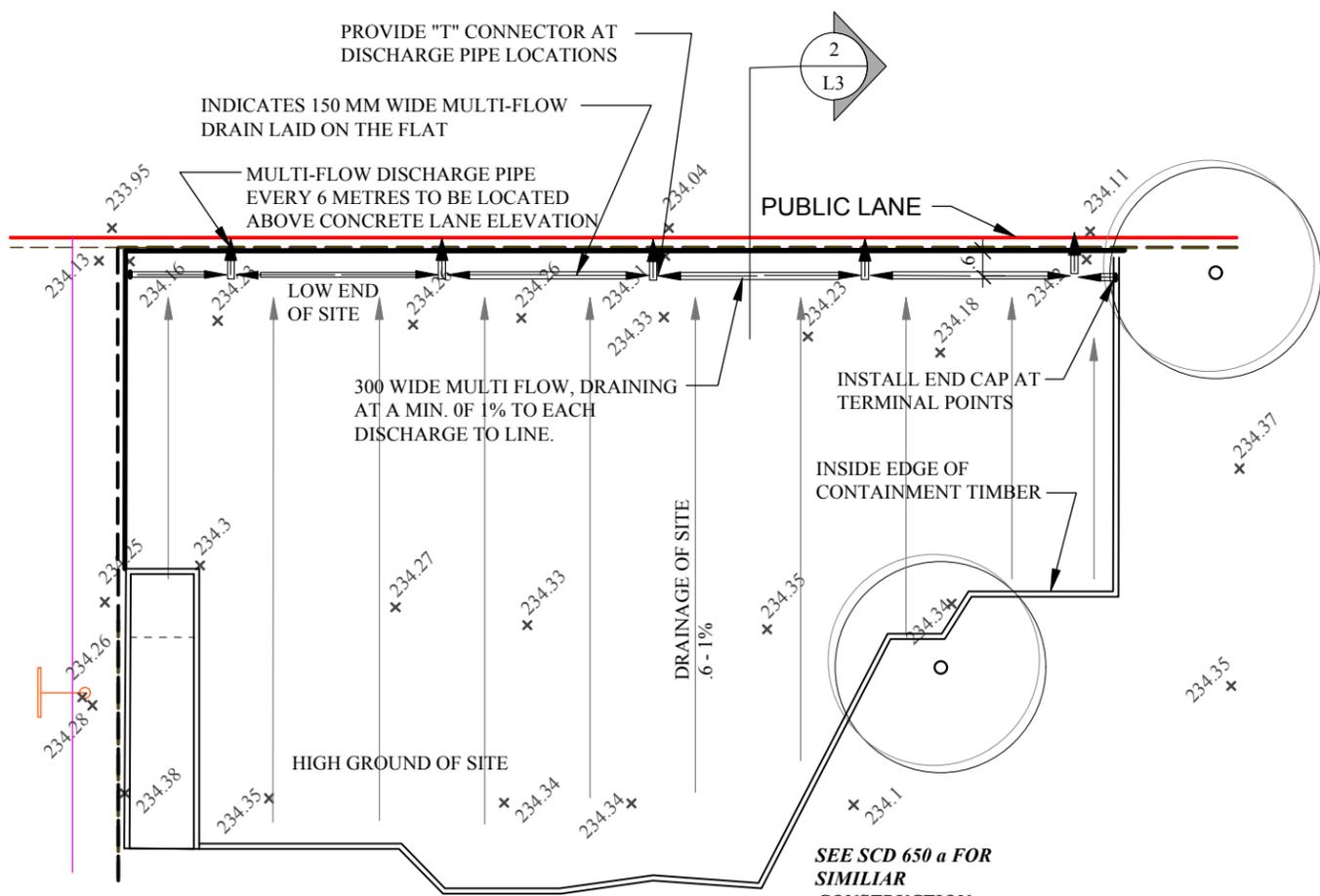
**1 WOOD FIBRE DRAINAGE DIAGRAM**
