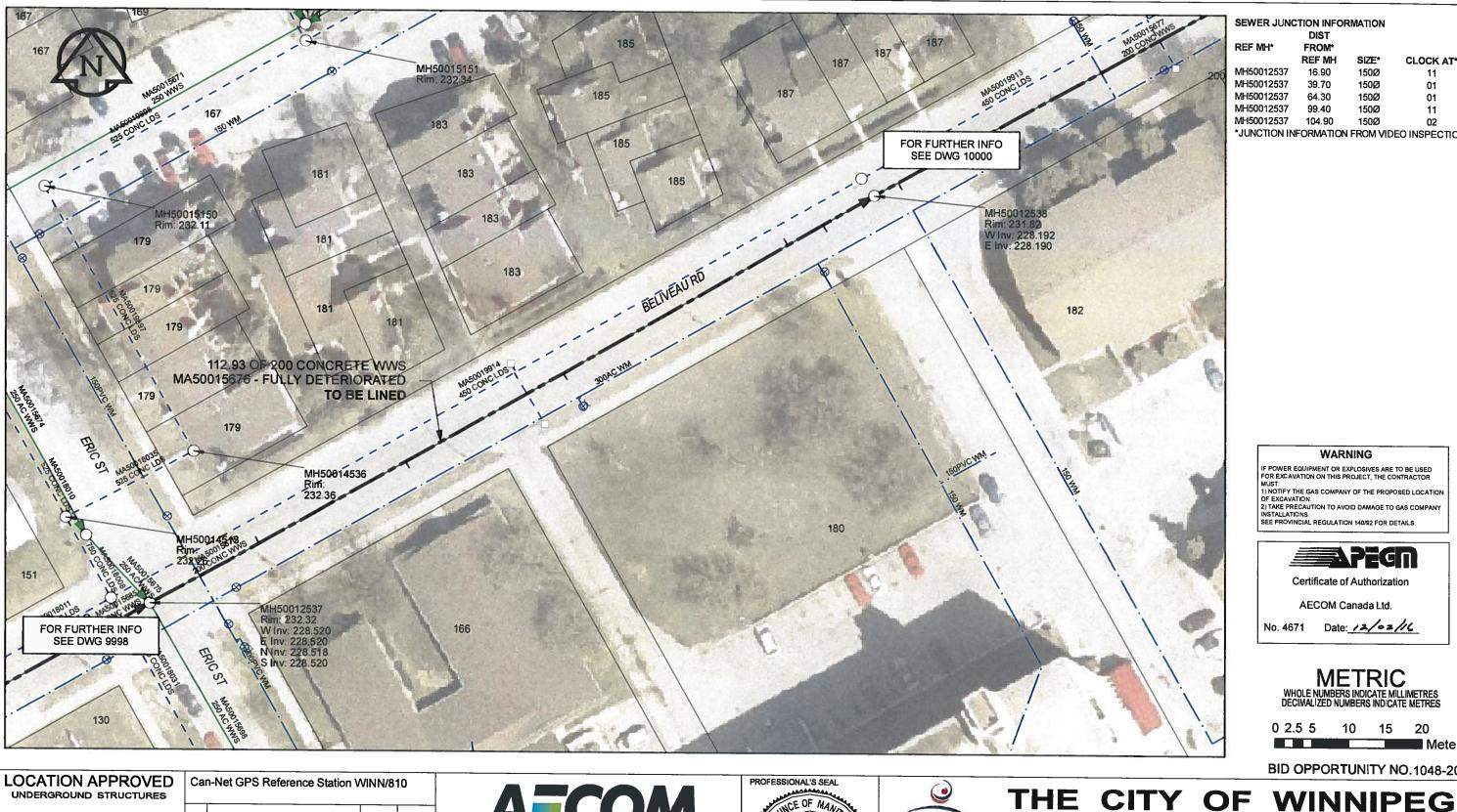
FROM' REF MH SIZE\* CLOCK AT\* MH50012537 16.90 150Ø 11 MH50012537 39.70 150Ø 01 MH50012537 64.30 150Ø 01 MH50012537 99.40 150Ø 11 MH50012537 104.90 150Ø \*JUNCTION INFORMATION FROM VIDEO INSPECTION
