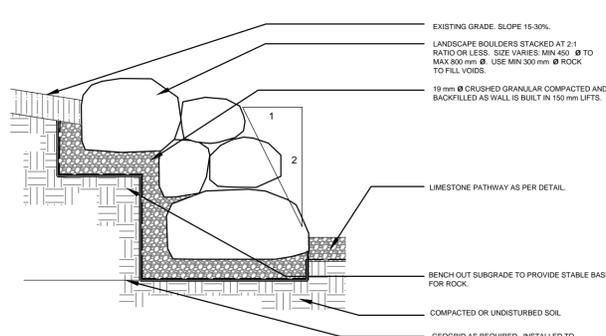
3 TYPE 4 - ROCK RETAINING WALL DETAIL
