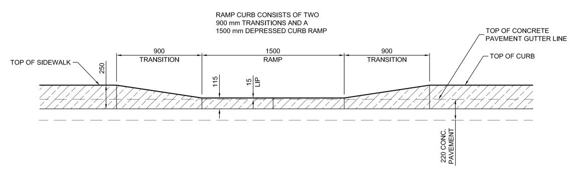
D TYPICAL 12 16 SCALE 1:20 TYPICAL CURB RAMP USING GRANITE
