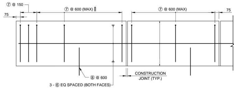
**APPROACH SLAB/TRANSITION ELEVATION**
