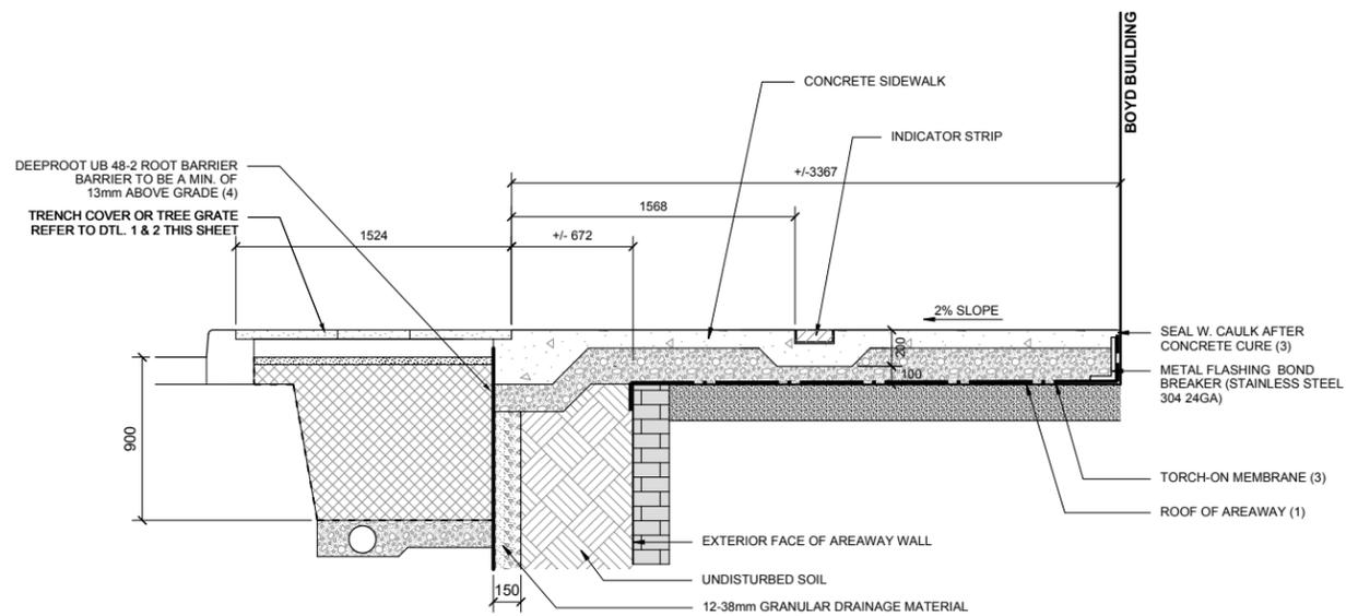
**3 TREE VAULT: SIDEWALK SOIL TRENCH & TREE WELL COVER - BOYD BUILDING AREAWAY**
