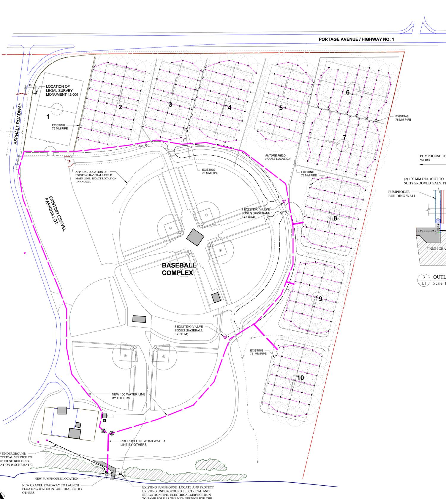
1 PUMPHOUSE LOCATION AND IRRIGATION LINE PLAN
