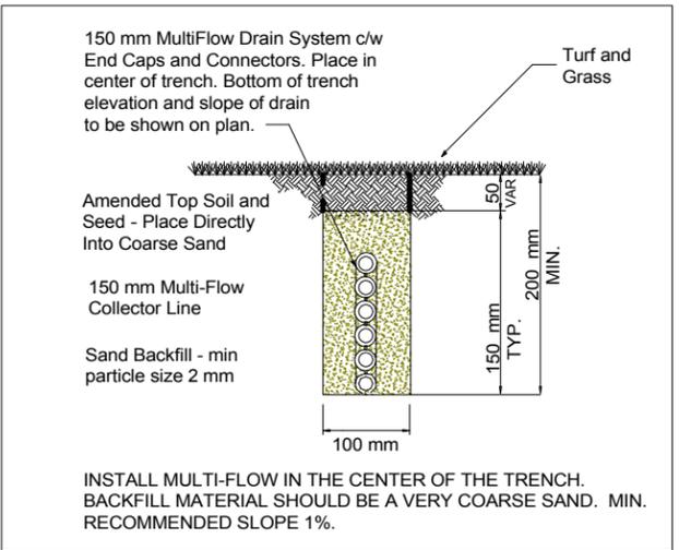
**SUBSURFACE DRAINAGE IN TRENCH DETAIL - NTS**
