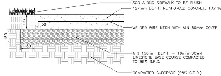
**2 REINFORCED CONCRETE SIDEWALK**
