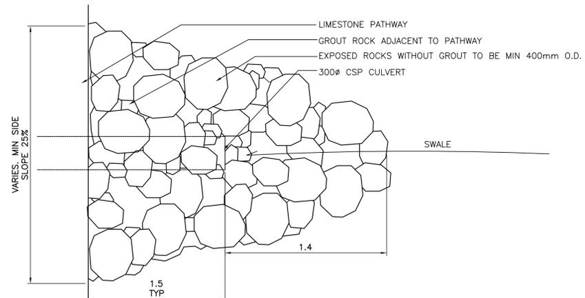
**8 TYPICAL CSP CULVERT**
