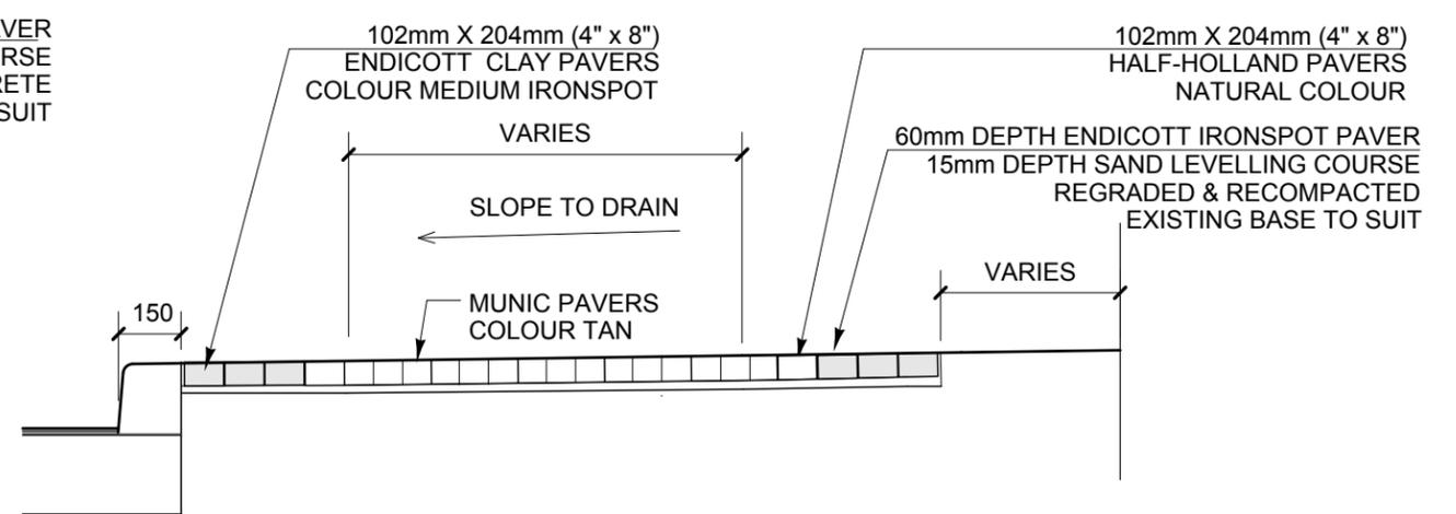
**2 REGRADED PAVER WALKWAY PAVING SECTION**
