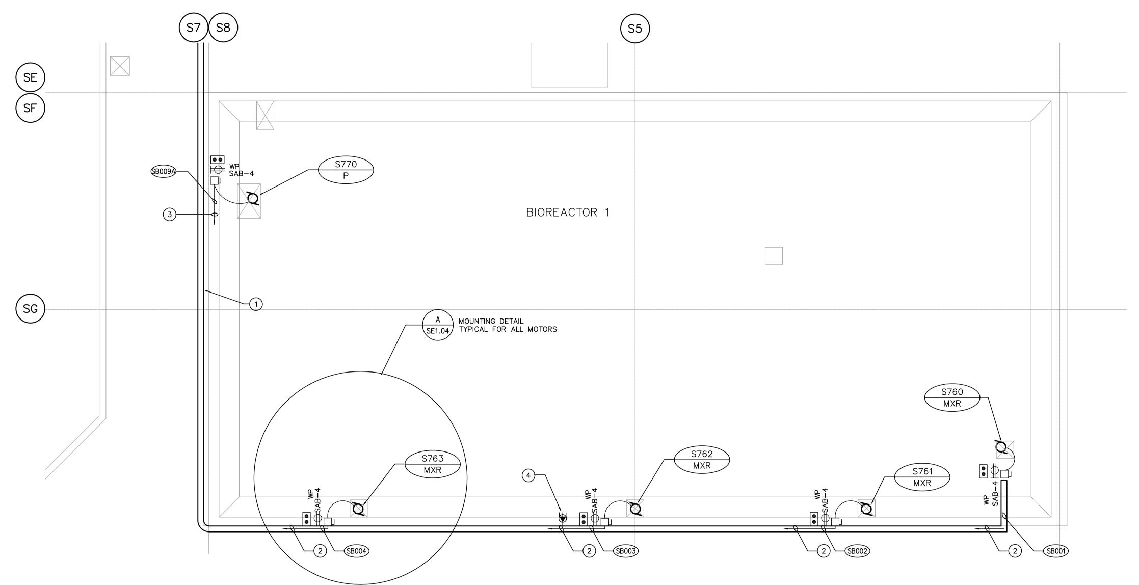
BIOREACTOR 1 — ROOF POWER PLAN
